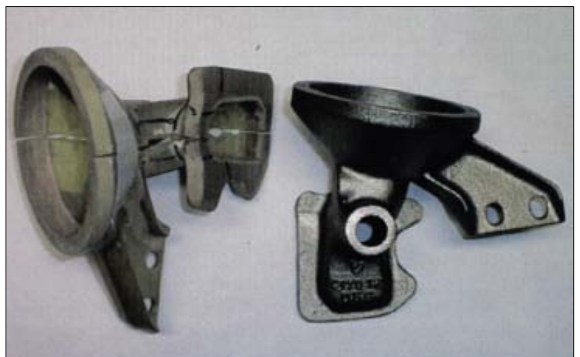
Bild 35: Stereolithographiemodell (links) und Gussteil (rechts) für den Konus eines Dieselmotorfilters aus GJSA-XNiSiCr35-5-2, Gewicht rund 2 kg (Bild: Buchholz, Zweibrücken)
