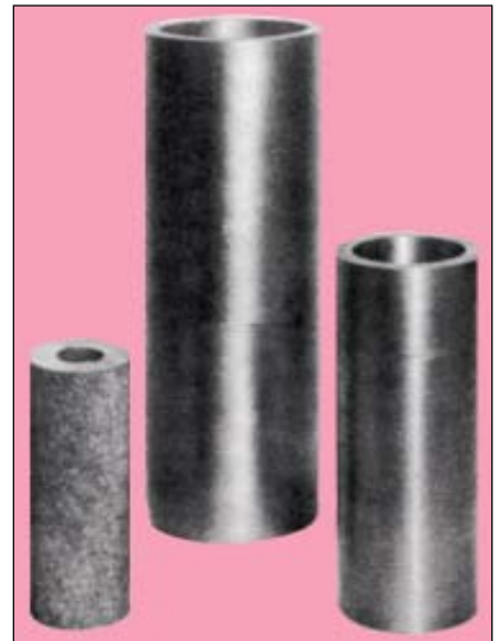
Bild 50: Schleuderguss-Lagerbüchsen für den Chemieanlagenbau - links Rohguss, rechts vorbereitete Abschnitte aus GJSA-XNiCr20-3 und GJLA-X15-6-2 (Bild: Kuhn, Radevormwald)
