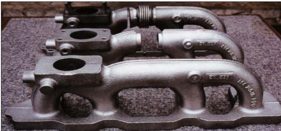
Bild 49: Abgaskrümmter aus GJSA-XNiSiCr35-5-2 mit eingeschweißtem Dehnungsglied, der einteilig gegossen, anschließend bearbeitet und geschnitten wird, bevor er ohne Vorwärmen geschweißt werden kann (Bild: Monforts, Mönchengladbach)
