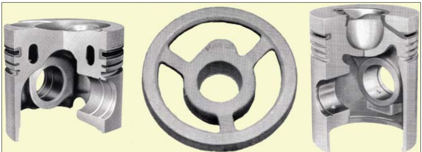
Bild 20: Zwei Leichtmetallkolben mit eingegossenem Ringträger (Mitte) aus GJLA-NiCuCr15-6-2 (Ringträger in Bildmitte ist mit Muldenrandarmierung kombiniert und gehört zum rechten Kolben) (Fotos: Mahle, Stuttgart)
