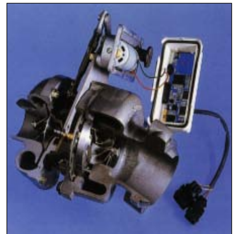
Bild 45: Turbolader von Allied Signal-Garret für den V8-Bi-Turbodieselmotor von BMW mit einem Turbinengehäuse aus GJSA-XNiSiCr 35-5-2 und einem Feingussteil Turbinenlaufrad aus einer hoch wärmfesten Nickellegierung (Bild: BMW München)
