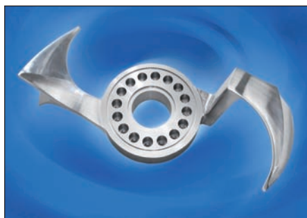
Bild 9: Mischschaufel aus GNiMo17Cr (Hastelloy C-4, W.-Nr. 2.4686) (Bild: Edelstahlwerke Schmees, Langenfeld/Pirna) (links)
