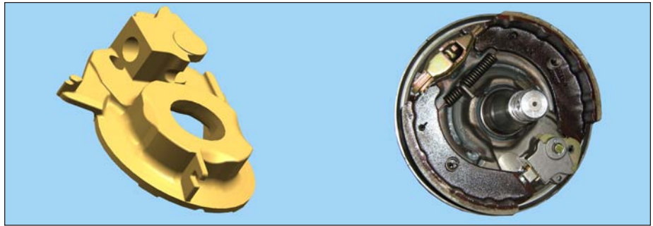
Bild 8: Gussteil Bremsträger aus der Sorte EN-GJMW-360-12 (Graphik links) und im Endzustand eingeschweißt in das Bremsgehäuse (rechts) (Bild: Knott, Eggstädt)
