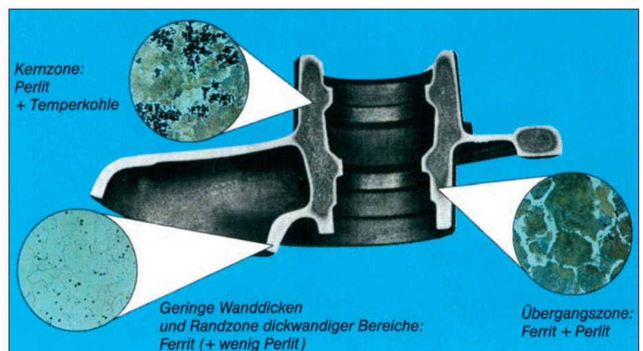
Bild 1: Infolge des entkohlenden Glühens in oxidierender Ofenatmosphäre hat Weißer Temperguss ein von der Wanddicke abhängiges Gefüge mit von außen nach innen zunehmendem Kohlenstoffgehalt.
