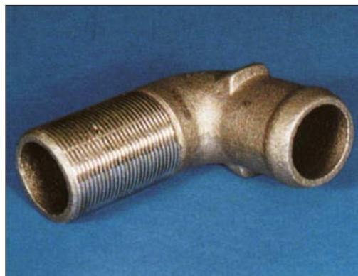
Bild 6: Fitting aus EN-GJMW-360-12 mit einem Schraub- (links) und einem Schweißanschluss (rechts)
