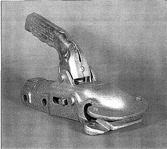
Bild 17: Fertig montierte Pkw-Anhängerkupplung mit einem Gehäuse und einem untenliegenden Verriegelungsstück aus EN-GJMW-450-7 (Bild: Nefit, NL-Deventer)
