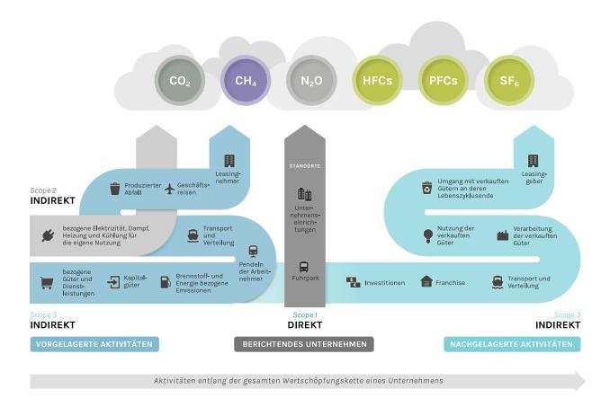
Abbildung 1: Übersicht über die Scopes nach dem GHG-Protokoll [WWF/CDP basierend auf GHG Protocol]
