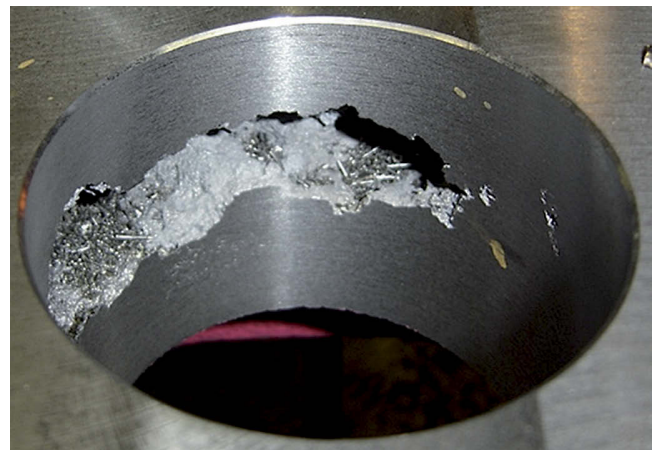
Bild 1: Angeschlossene Lunker, welche, wenn möglich, zugschweißt werden könnten.
