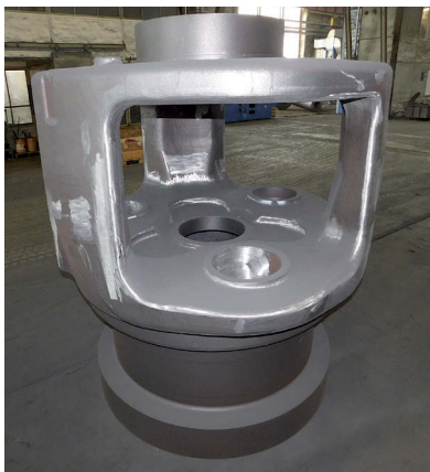
Bild 2: An Demonstratorbauteilen wird die Anwendbarkeit der zu erarbeitenden Reparaturschweißmethode validiert. Links: Planetenträger, rechts: Maschinenträger.
