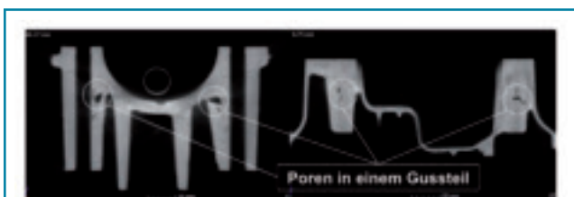
Bild 1: Mittels Computertomografie ermittelte Porenverteilung in einem Druckgussteil.
