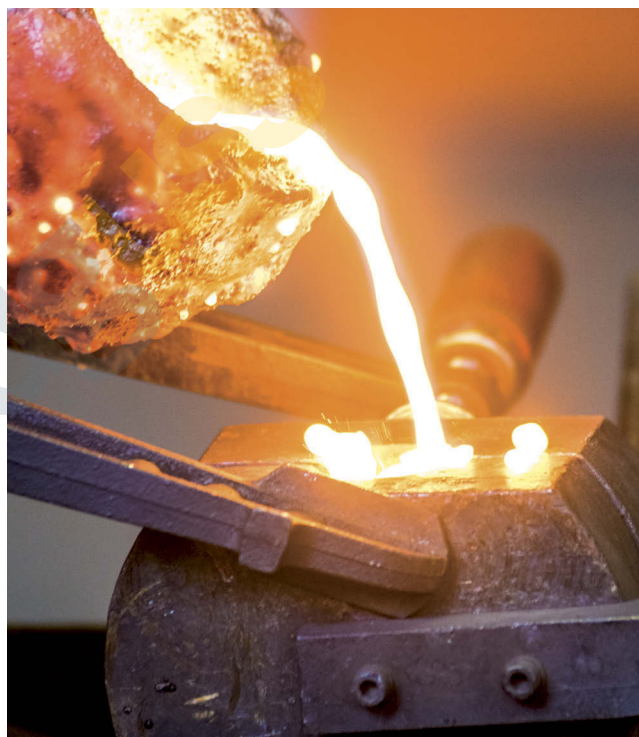
Bild 2: Abguss für eine umfassende Schmelzanalyse.
