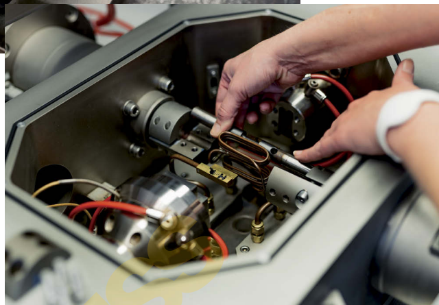
Bild 10: Materialcharakterisierung am Umformdilatometer.
