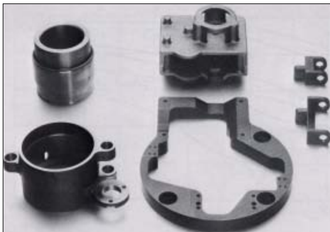
Bild 15: Teile für ein optisches Präzisionsinstrument für den Einsatz im Temperaturbereich von -25 bis 55 °C aus GJSL-XNi35, die den gleichen Wärmeausdehnungskoeffizienten wie das Glas der Optik haben (Bild: Wolfensberger Bauma (CH))
