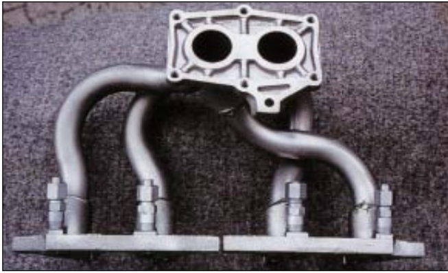
Bild 17: Aus Stahlrohren und Gussflanschen montierter Krümmer aus GJSA-XNiCrNb20-2 (Bild: Monforts, Mönchengladbach)
