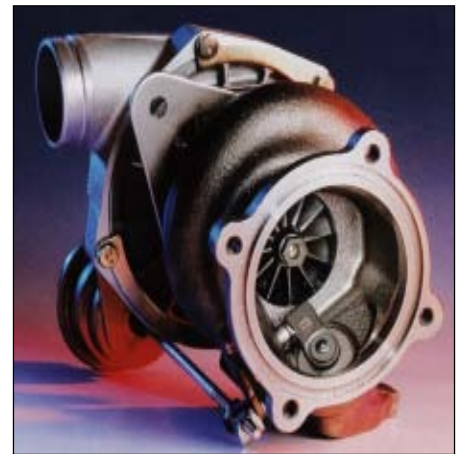
Bild 46: Turbolader für Porsche 911 Turbo mit einem Gehäuse aus GJSA-XNiSiCr35-5-2 (Bild: 3K-Warner, Kirchheimboladen)
