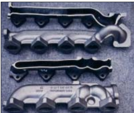
Bild 41: Dünnwandiger Abgaskrümmer für 8-Zylinder-Otto- und -Dieselmotor aus GJSA-XNi-SiCr35-5-2 (Bild: Montforts Mönchengladbach)
