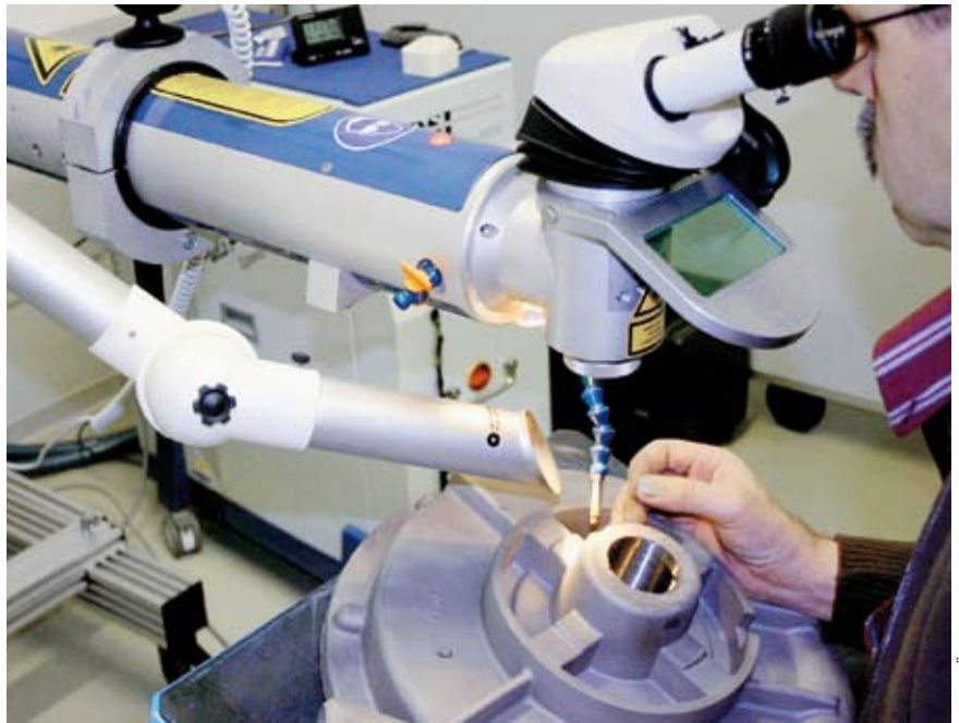
Bild 1: Manuelles Laserstrahlschweißen im Miniaturbereich mit Hilfe eines Mikroskops
