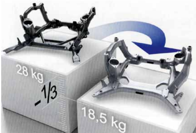
Bild 5: Materialeinsparung um 1/3 durch Substitution einer tragenden Stahlstrukturkomponente für ein Fahrzeug durch ein Druckgussteil [41].
