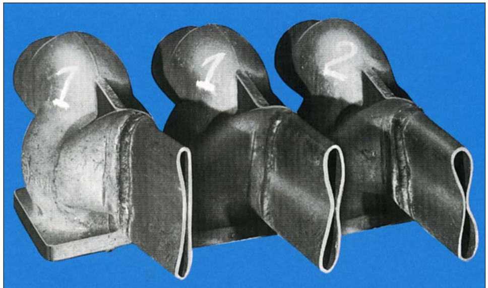
Bild 3: Ventilgehäuse aus EN-GJMW-360-12, das schweißtechnisch mit einem Stahlrohr vorge-schuhrt wurde.
