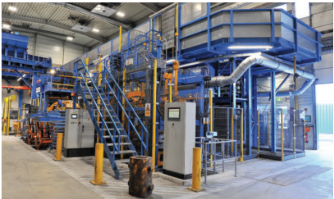
Bild 9: Das Unternehmen Friedr. Lohmann realisierte am Standort Witten-Annen eine neuartige modulare Fertigungslinie für das Formen und Gießen von Sandgussbauteilen
