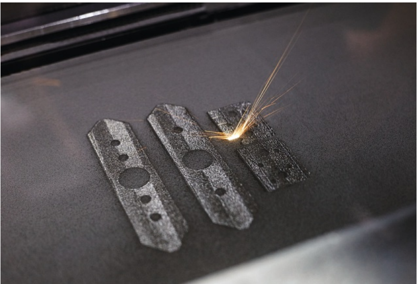
Bild 2: Der von Protiq entwickelte Prozess zur Verarbeitung des Zinkmaterials Zamak im selektiven Laserschmelzprozess erlaubt die Herstellung von Prototypen und Serienbauteilen.
