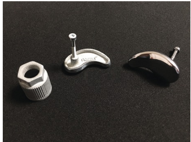
Bild 3: Additiv gefertigte Bauteile mit anschließender Oberflächenbeschichtung in Chrom. Von der HDO Druckguß- und Oberflächentechnik GmbH aus Paderborn stammen das Bauteildesign und die galvanische Oberflächenveredelung.
