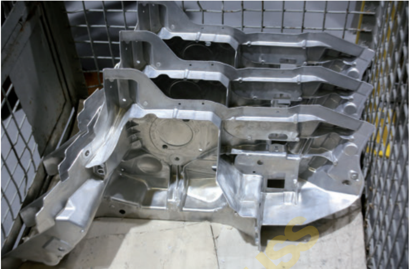
Das auf der Euroguss 2018 prämierte Gussteil besticht durch große Abmessungen bei extremer Dünnwandigkeit.
