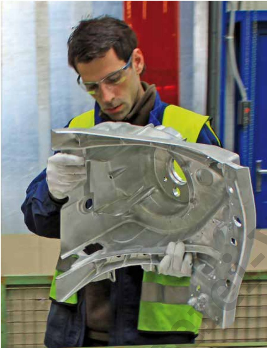
Bei der Schlussinspektion dieses fertig bearbeiteten Federbeindoms für den Mercedes GLC (BR 253) kommt es auf höchste Sorgfalt an.
