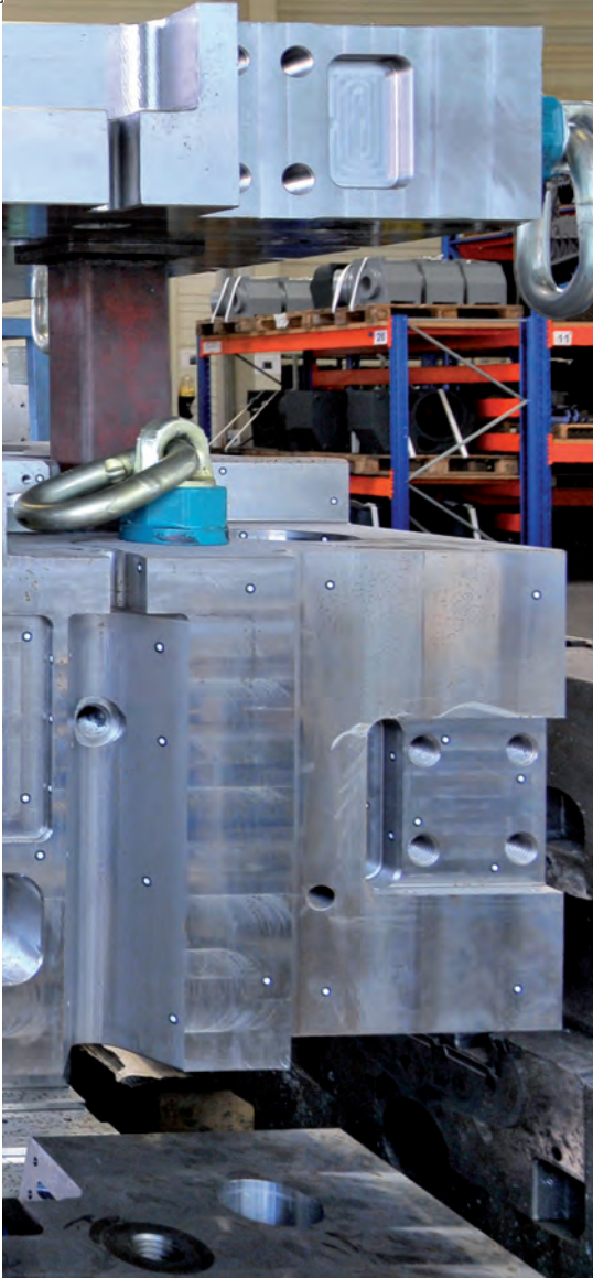
Formaufbau für einen Längsträger in der Montage von Schaufler Tooling.
