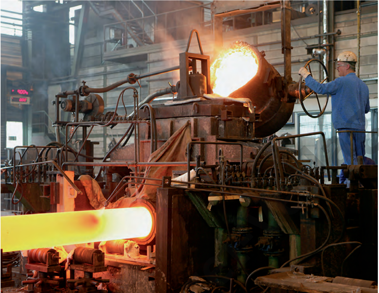
Stranggießanlage für ein rundes Strangprofil bei Gontermann-Peipers in Siegen.
