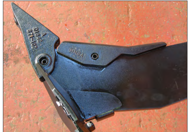
Bild 4: Komplett montiertes Bauteil „Solo Subsoilers“ von SIMBA. Der „Spitzenbeinschutz“ aus dem Werkstoff CADI, welches auch das Firmenlogo enthält, ist direkt hinter dem Spitzenschuh aus Cr-legierten Gusseisen montiert.
