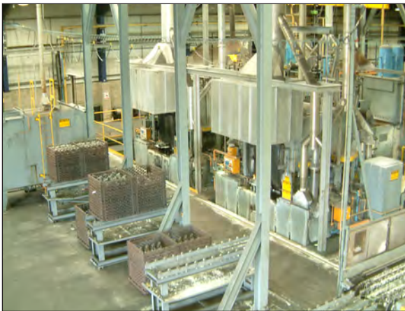
Bild 1: Der Wärmebehandlungsofen zur Herstellung von ADI- und CADI-Gusseisen (links). Die Anlage ermöglicht die Wärmebehandlung von Bauteilen bis zu 1,8 m Durchmesser; Schematische Darstellung des Wärmebehandlungsofen-Systems (rechts).
