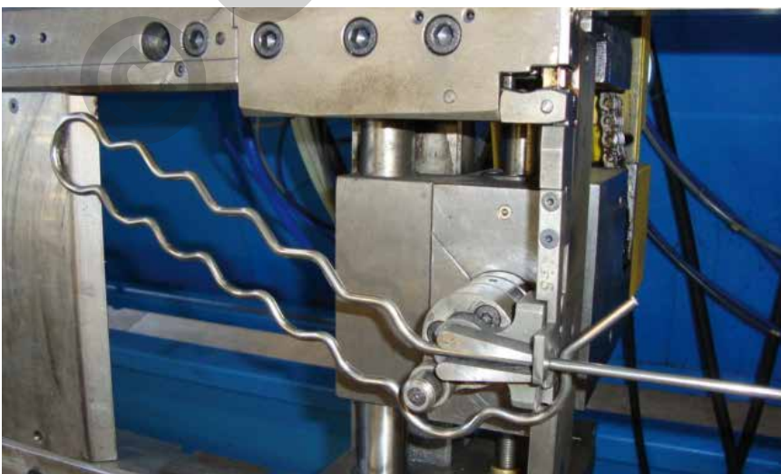
Bild 4: CNC-Biegemaschinen realisieren komplexe Geometrien der Combicore-Einlegerohre.
