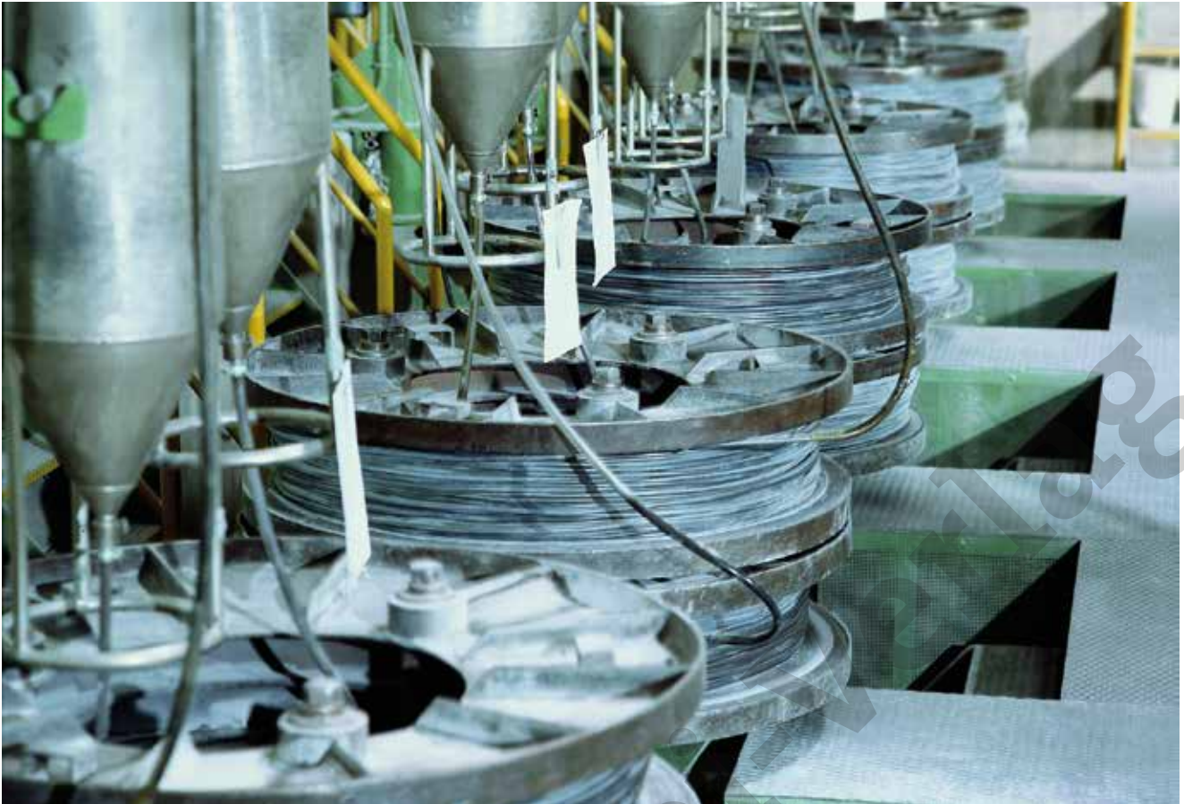
Bild 3: Das auf eine Spule gewickelte, über 1000 m lange Rohr gewährleistet eine gleich bleibende Qualität und Maßhaltigkeit der späteren Kerne.
