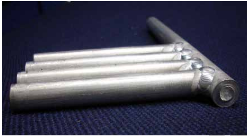
Bild 5: Einzelkerne können zu handlichen Kernpaketen zusammengefügt werden.
