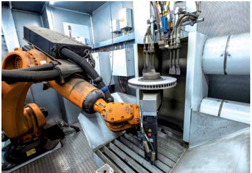
Flammspritzpistolen kurz vor dem Einsatz: Beschichtet wird sowohl die Unter- als auch die Oberseite der Bremsscheibe.
