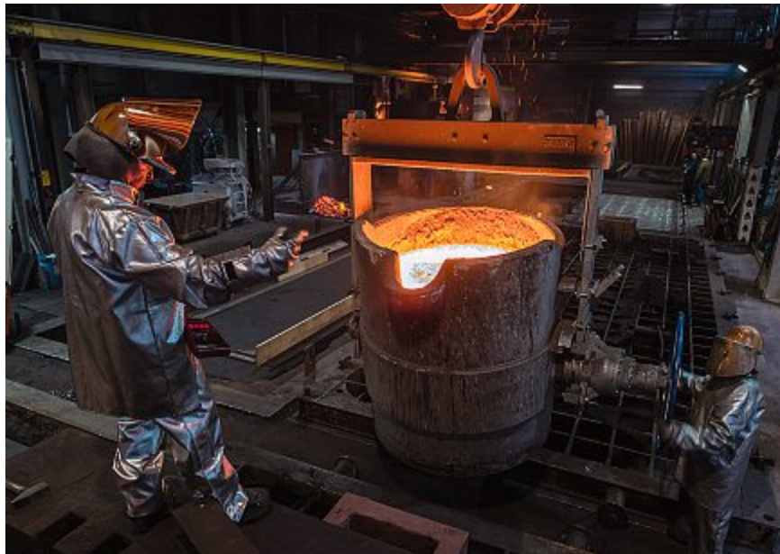
Vorsichtig winkt Gießereimeister Josef Schmahl die gewaltige Schmelzpfanne heran. Gleich startet der Abguss in die Eingießtrichter an beiden Seiten der meterlangen Bodenform.
