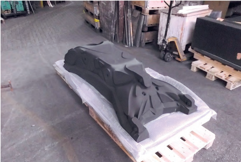
Bild 3: Die fertige Gussform und -kerne aus Quarzsand treffen bei Pro Cast Guss ein. Die Gießerei aus Gütersloh ist für den Guss der Fahrwerksschwinge verantwortlich.
