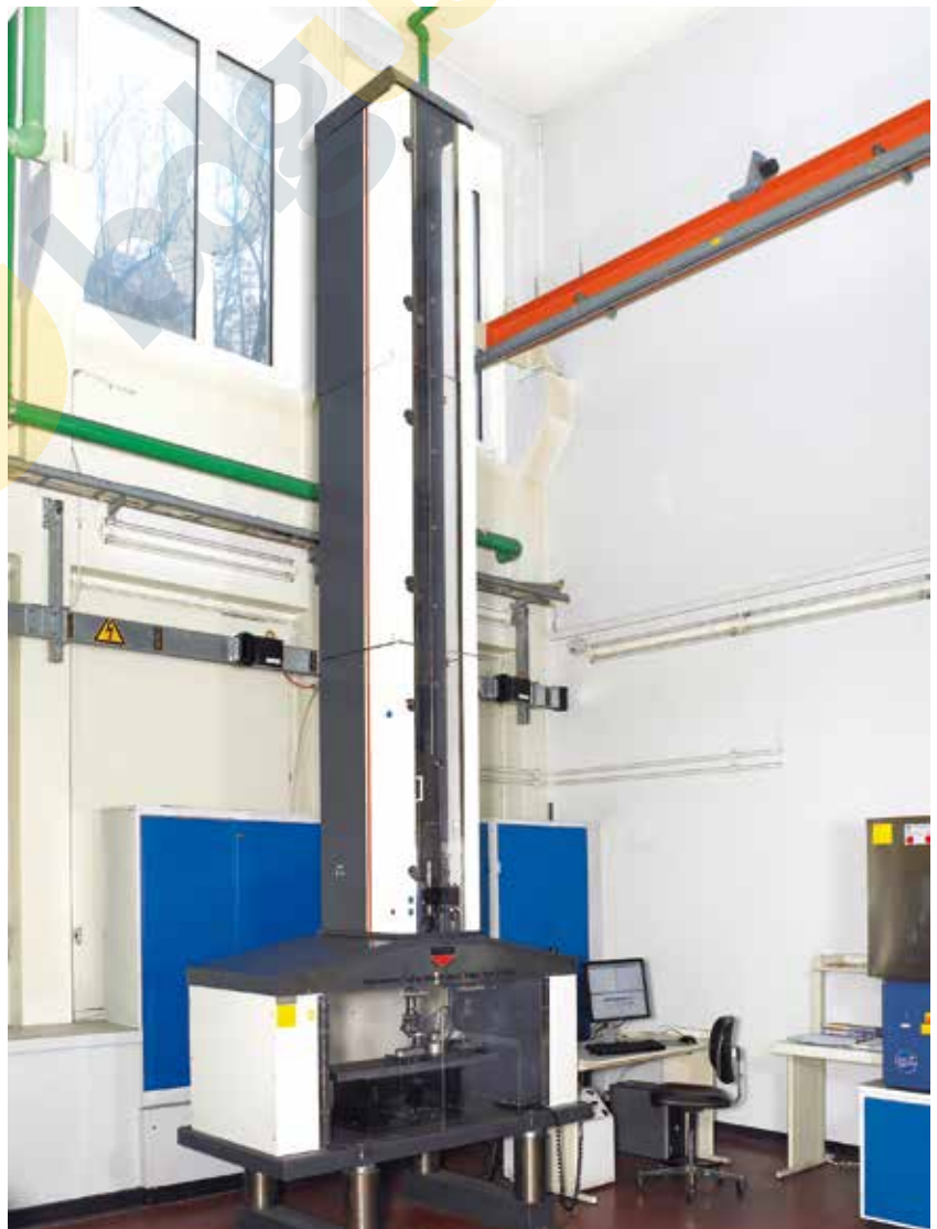
Bild 2: Rosand-Schlagprüfanlage für instrumentierte Schlagversuche.
