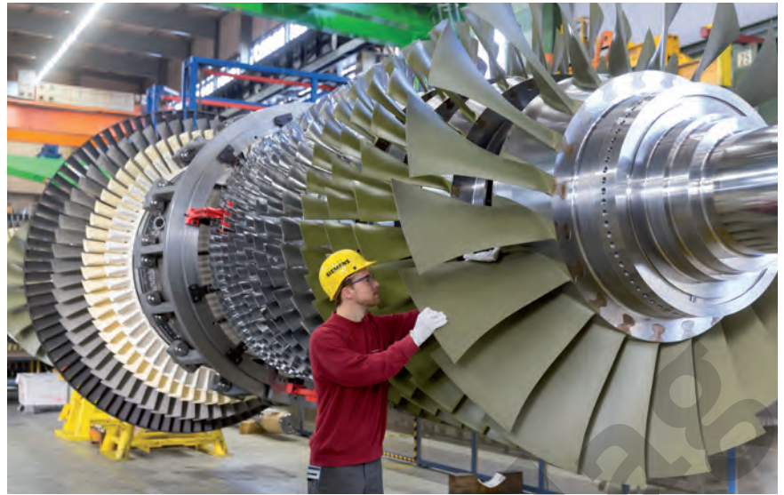
Bild 1: Montage einer SGT5-8000H-Turbine für ein GuD-Kraftwerk in Düsseldorf. In diesen hocheffizienten Kraftwerken könnten besonders temperaturbeständige Kraftwerksstähle die Wirkungsgrade weiter erhöhen.
