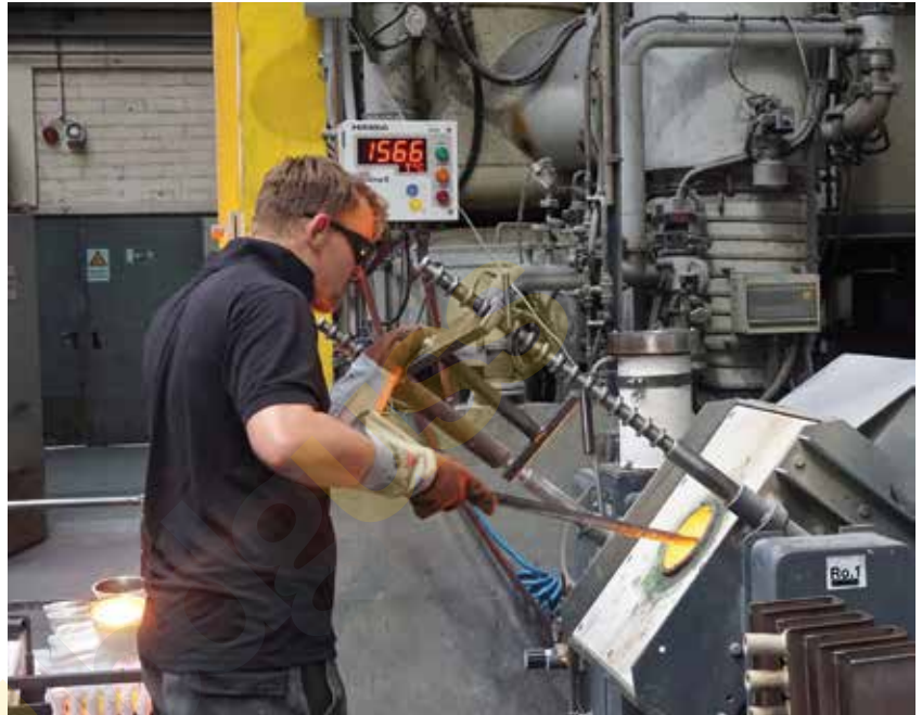
Schmelzen und Gießen: Ein Arbeiter bereitet die Schmelze für den Abguss in Keramikformen vor.
