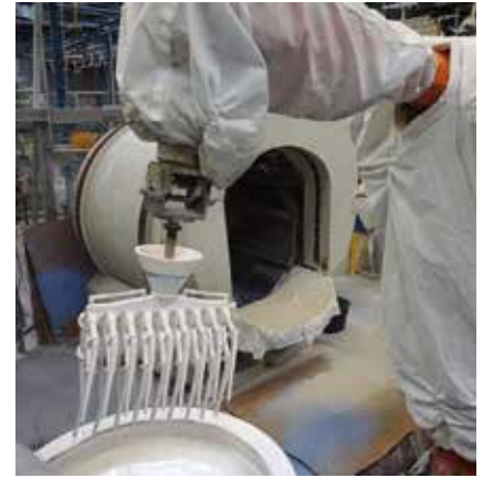
Tauchprozess: Ein Roboter überzieht die Trauben anschließend mit einer oder mehreren Keramikschichten.
