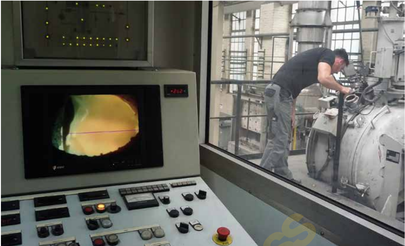
Titangießen: Das Display im Kontrollraum zeigt den Schmelzprozess des Titans. Gleich wird der Werker eine Keramikform in einer luftdichten Kammer für den Abguss bereitstellen.
