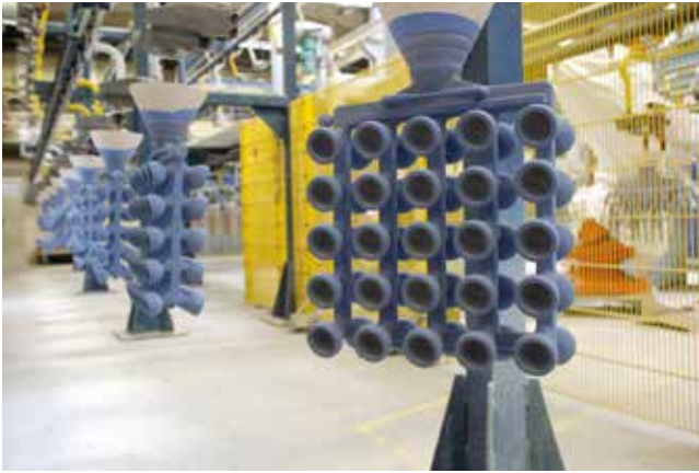
Modelle: Wie an einer Seilbahn schweben diese Wachsmodelltrauben langsam durch die Werkshalle.
