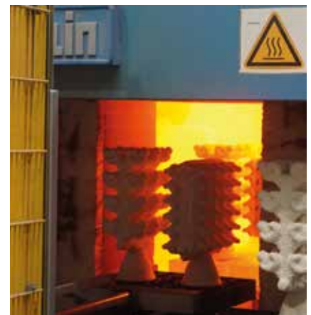
Brennen: Bei großer Hitze wird das Wachs ausgeschmolzen und die Form gebrannt.
