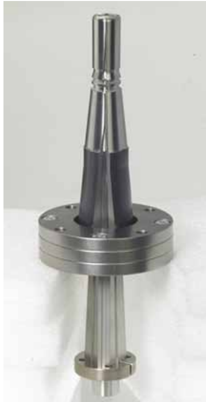
Bild 6: Fährt der Zentralkern ein, drückt er die äußeren Segmente radial nach außen.
