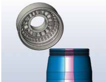
Bild 3: Gewinde mit Stegen auf der Stirnseite.
