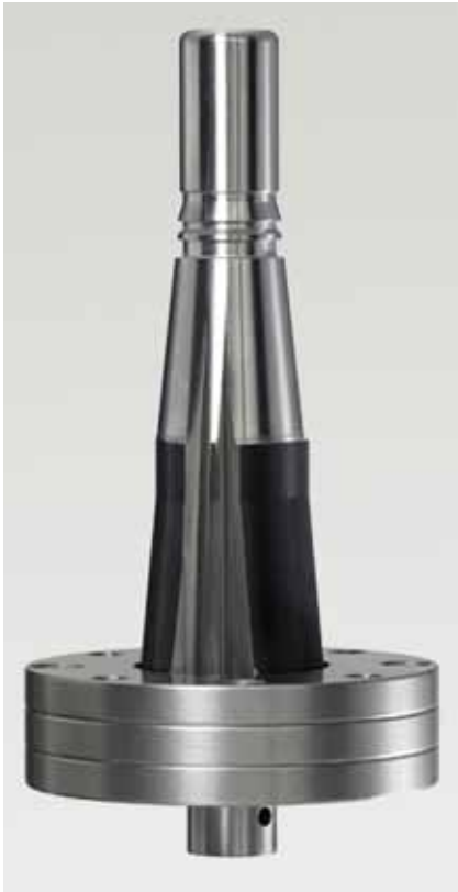
Bild 5: Um den konischen Zentralkern des Einfallkerns herum sind mehrere äußere Segmente gruppiert.
