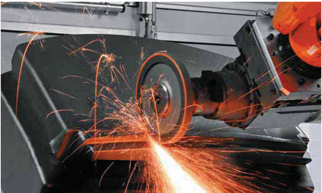
Bild 5: Schleifapplikationseinsatz mit Force Control.
