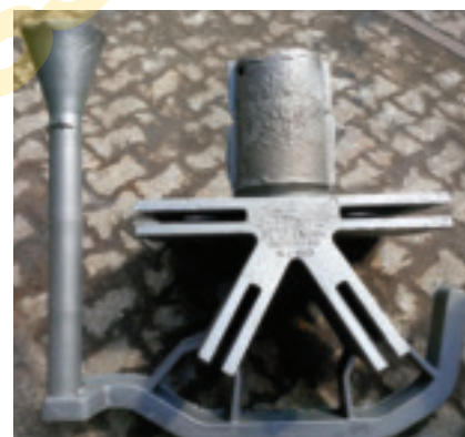
Bild 7: Fertiges Gussteil mit Gießlauf und Speiser nach dem Auspacken und Sandstrahlen (Foto: Fa. Schmees)
