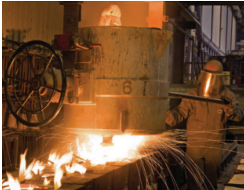
Bild 6: Abguss der Knotenelemente bei Schmees in Langenfeld.
