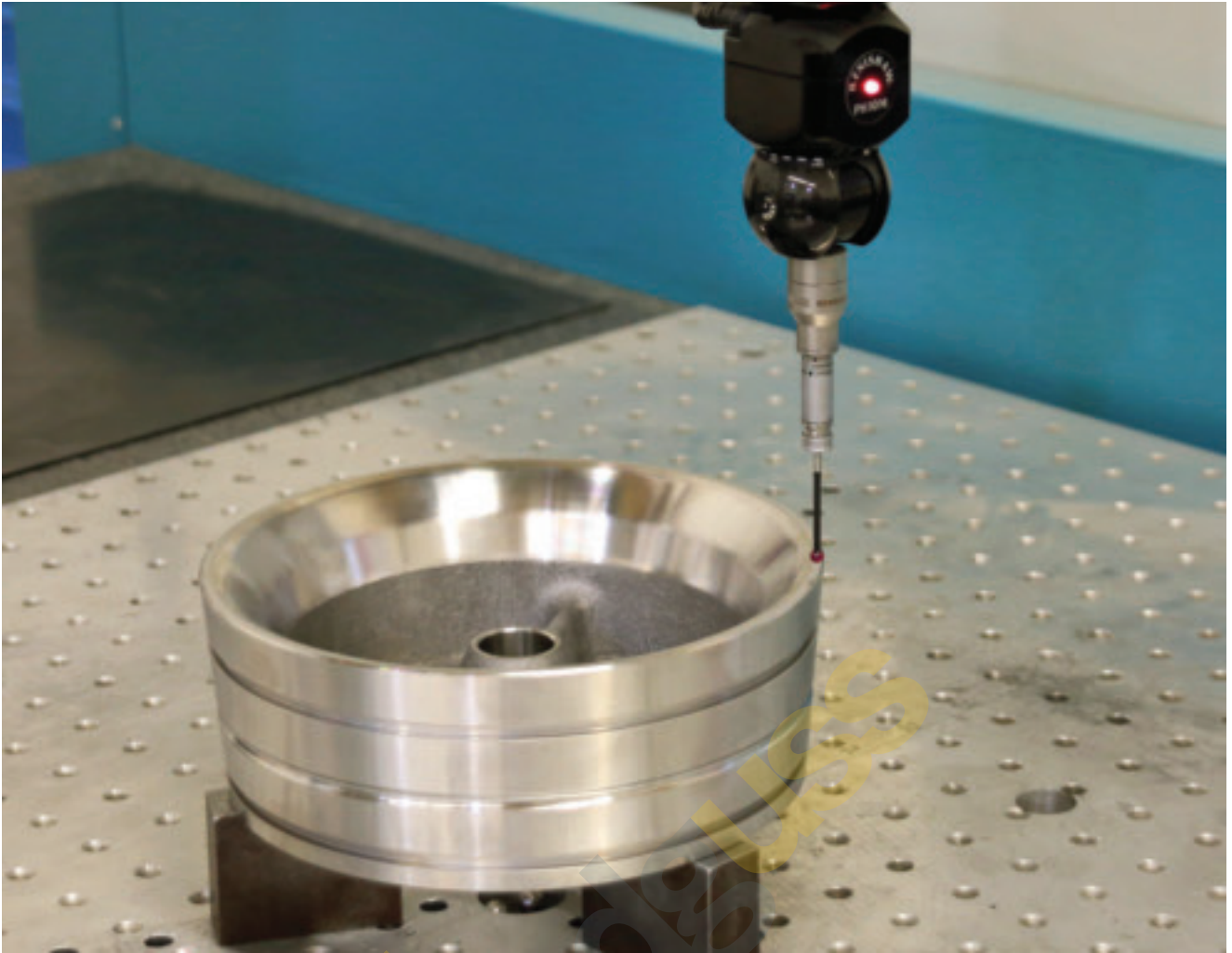
Mit hoher Präzision gedrehter Ventilsitz aus G-X 200Cr Mo 25 3 für eine Pumpe zur Förderung stark schleißender Suspensionen im Bergbau.
