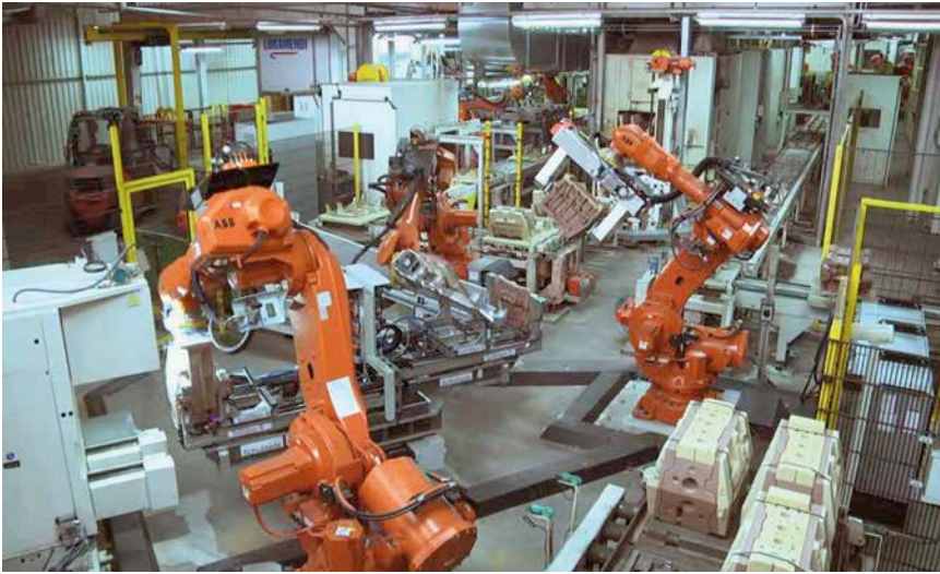
Bild 8: Die neuen Kernfertigungscentren (CBL 300) bei EB.
