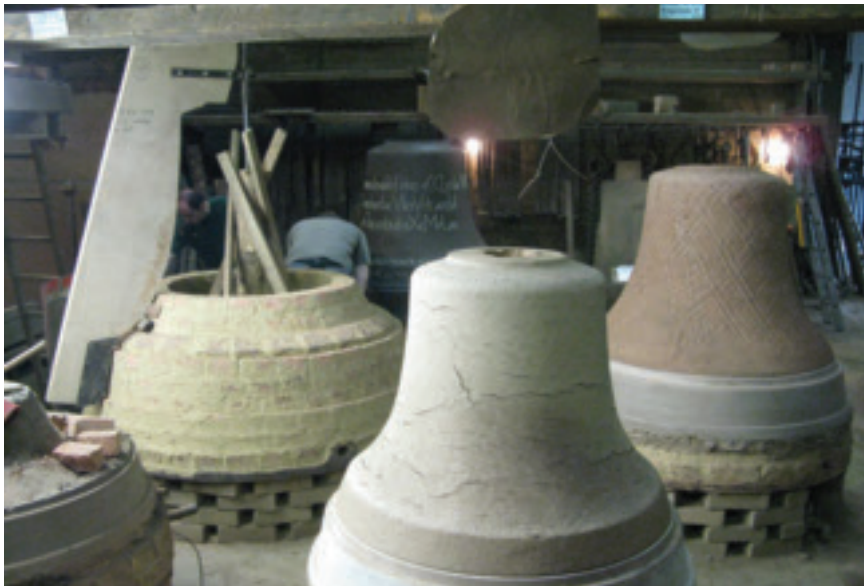
Bild 3: Links: ein halbfertig gemauerter Kern mit Schablone. Vorne, rechts und hinten: drei „Falsche Glocken“ in verschiedenen Formungsstadien.
