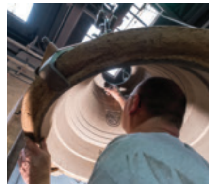
Bild 8: Der Mantel wird abgehoben, das Wachs der Inschriften ist ausgeschmolzen. Zurück bleiben Vertiefungen, die beim Abguss der Glocke eine erhabene Inschrift zurücklassen.
