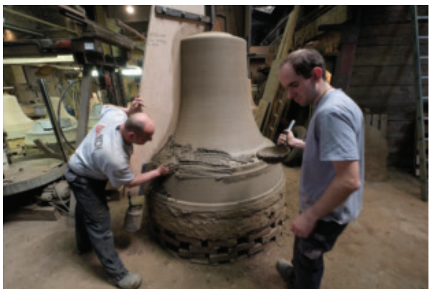
Bild 4: Schablonierung des Kerns mit Lehmischungen.
