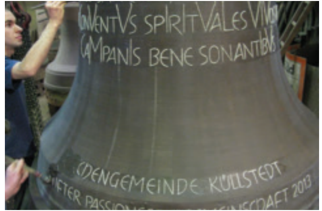
Bild 6: Vor der Formung des Mantels wird eine Zierlehmschicht aufgebracht, die an der Luft trocknet.
