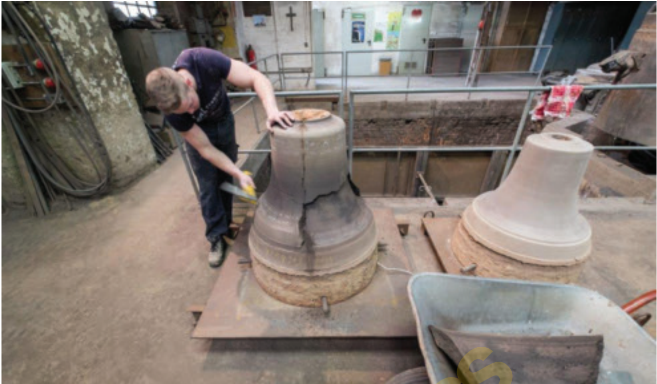
Bild 9: Die Falsche Glocke wird vorsichtig zerschlagen, dann werden Mantel und Kern für den Guss vorbereitet und der Mantel auf den Kern aufgepasst.
