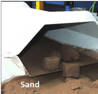
Bild 3: Separierter Austrag der Kernsande, der Späne und der Gießsystemteile.
