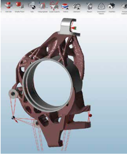
Bild 5: Topologieoptimierungsprozess mit solidThinking Inspire.
