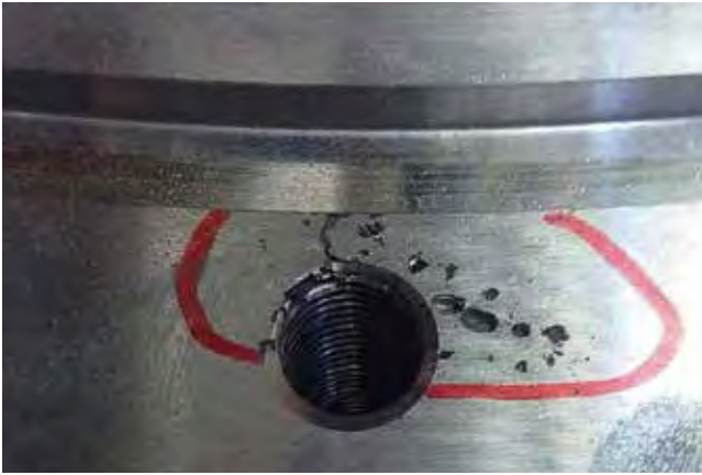
Gussteil mit Fehlstelle vor der Bearbeitung
