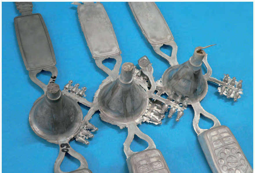
Bild 8: Verfahrensmöglichkeiten beim Magnesiumdruckgießen: mit Pfropf, ohne Pfropf, Abschmelzen (v. l. n. r.).
