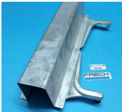
Bild 10: Im Rahmen von Laborversuchen im Frech-Technikum hergestelltes Magnesium-gussteil.
