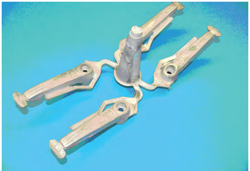
Bild 9: Durch bessere Entlüftung wurde bei diesem Gussteil die Mikroporosität gesenkt.
