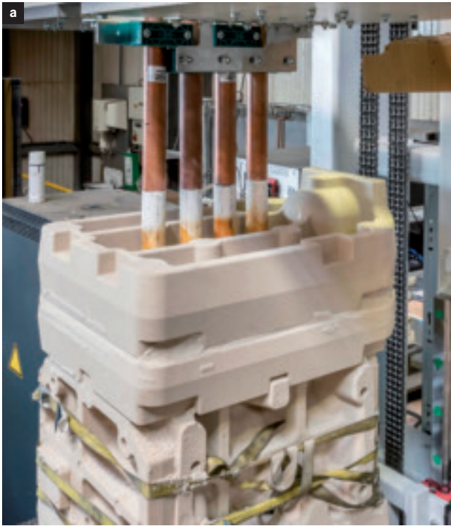
Bild 2a+b: Schnelles Ergebnis: Der Niederdruck-Sandguss hat eine Zykluszeit von maximal zwei Minuten.
