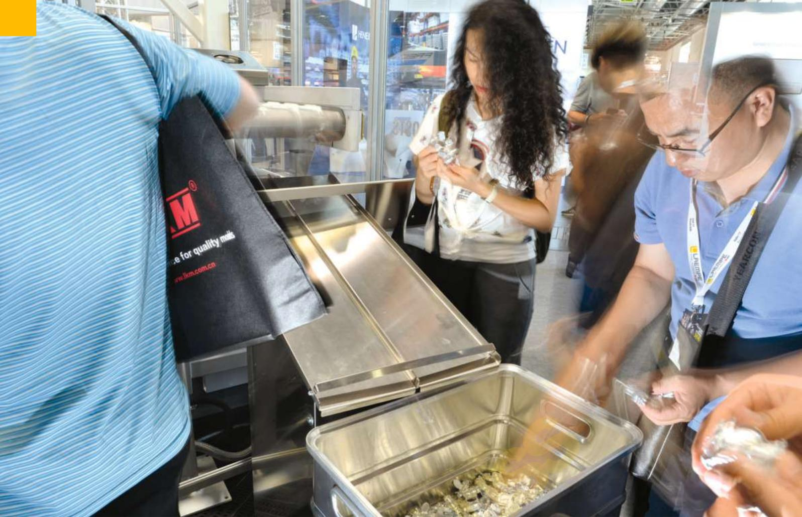
Heftig umlagert: die Druckgießmaschine von Oskar Frech am Stand der VDG-Akademie. Sie fertigte Tierhälften – Biene und Löwe – aus Zink. Unten ein fertiges Tier.
