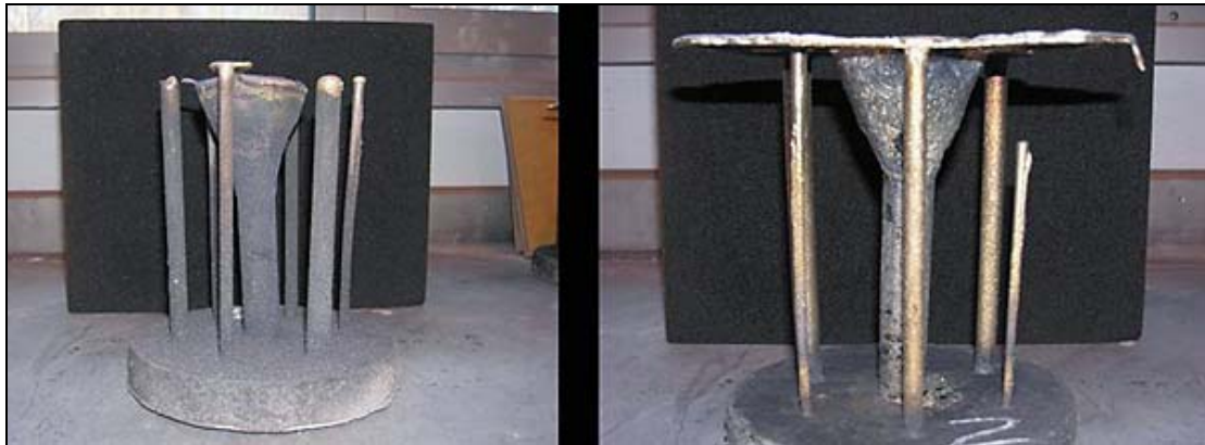
Bild 4: Formfüllversuch mittels Gießharfe (links „DIEHL 432 PbF“, rechts CuZn39Pb2Al): Insbesondere der Vergleich der Füllhöhen der 3 mm-Kavität (rechte Säule in beiden Bildern) zeigt das bessere Formfüllungsvermögen der Legierung „DIEHL 432 PbF“.
