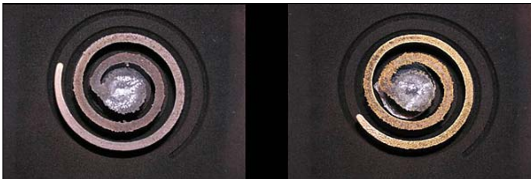
Bild 3: Gussproben aus der Gießspirale: Links ist die Legierung „DIEHL 432 PbF“, rechts die Standard-Gusslegierung CuZn39Pb2Al dargestellt. Die neue Legierung hat im Vergleich zur Referenzlegierung eine um fast 10 % größere Auslaufhöhe. Dieser Vergleich demonstriert die sehr gute Gießbarkeit.
