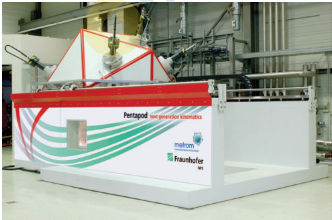
Bild 7: Multifunktionale parallelkinematische Anlage zum Rührreißschweißen: Pentapod-PG-2000.
