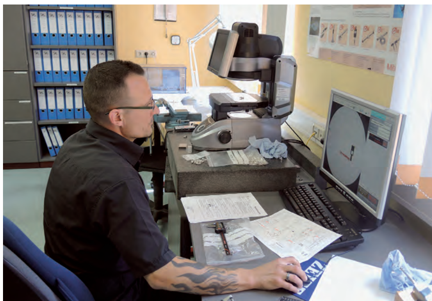
Messtechniker Alex prüft ein kleines Elektronikgehäuse mit dem neuen optischen Profilprojektor der Firma Keyence Deutschland GmbH, Neu-Isenburg.
