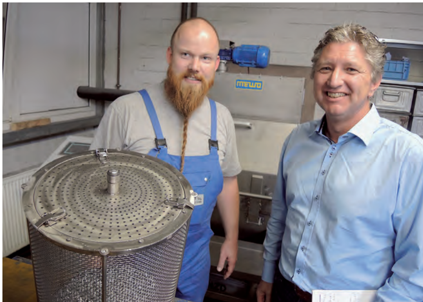
Matthias Manns und Ralf Sinner vor der kryogenen Entgratungsanlage, mit der die Hausanschlussverstärker entgratet werden. Vor ihnen der Korb für die Schüttgüter, der manuell in die Maschinen gestellt wird.
