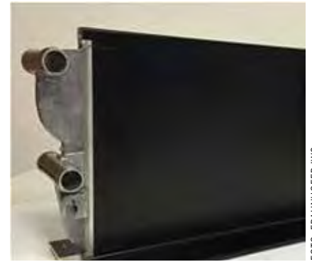
Bild 11: Lasergeschweißte Kühlkomponente, bestehend aus einem Hohlprofil und zwei Druckgussflanschen.
