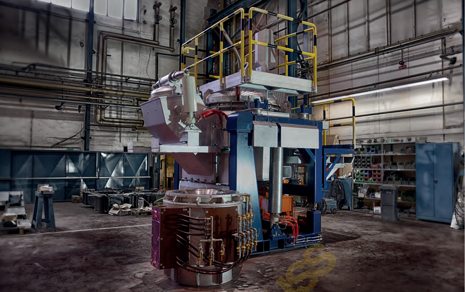
OCN-25-Ofensystem von ABP Induction - Das Niederdruckgießen stellt eine vielversprechende Alternative für Stahlguss dar.
