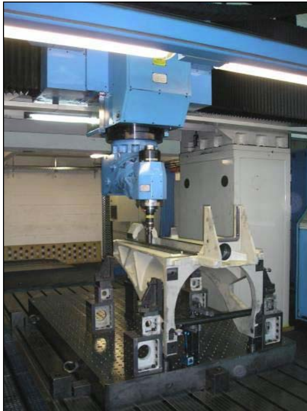
Bild 1: Fahrständer- und Genauigkeits-Portalfräsmaschine (Werkbild Heidenreich & Harbeck AG)
