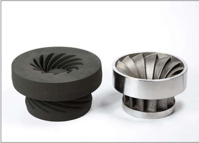
Bild 2: Gedruckte Sandform und bearbeitetes Endprodukt.
