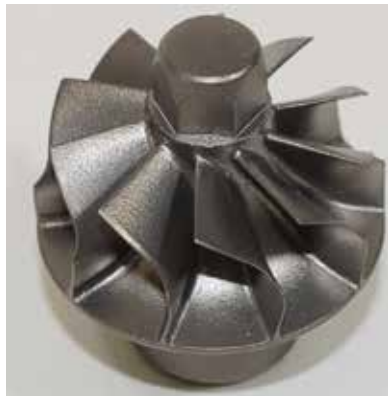
Bild 10: Turbinenrad aus TiAl, hergestellt durch Schleudergießen.
