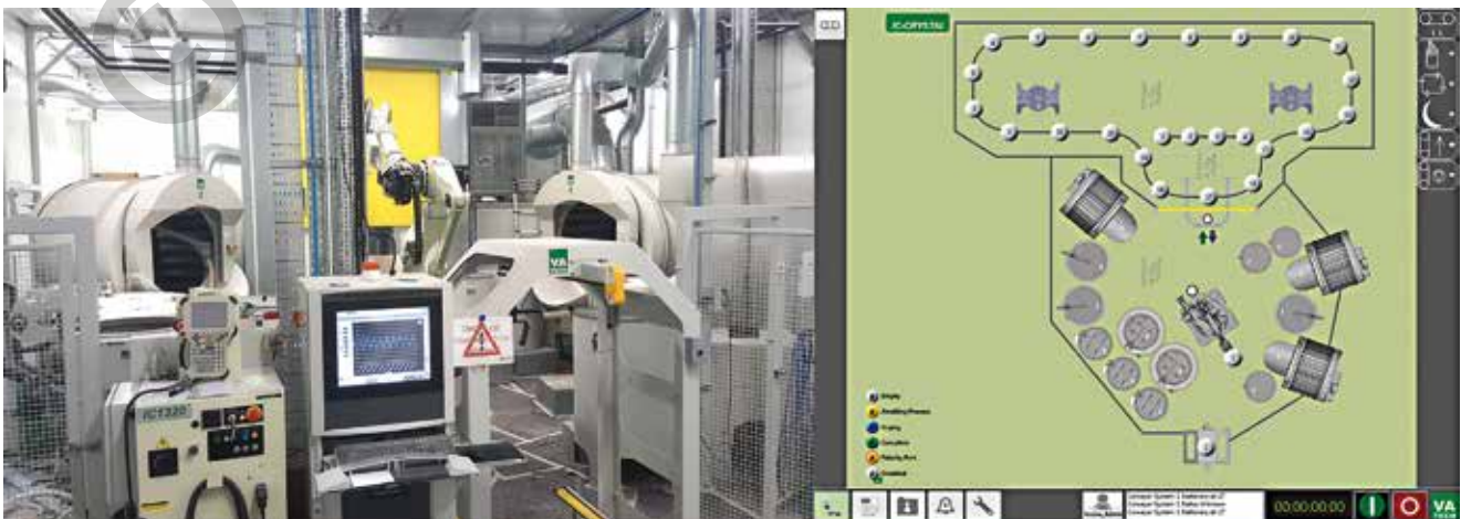
Bild 6: Anlage zur vollautomatisierten Formschalenherstellung der Fa. VA Tech bei Access e.V.
