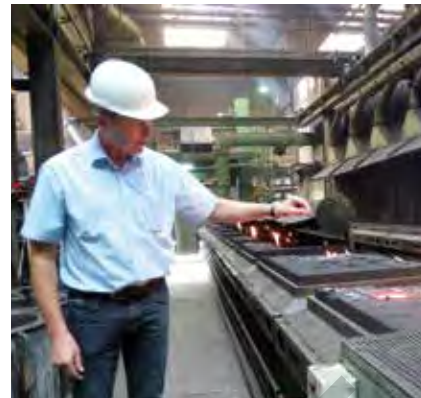
Nach dem Abguss: An der Oberfläche des Formkastens entweicht Gas, das aufgrund der Hitze des flüssigen Metalls verbrennt.
