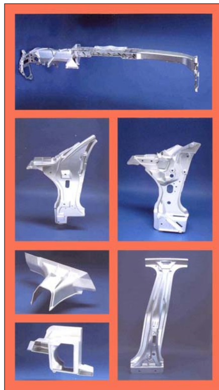
Bild 1: Strukturteile aus Aluminiumdruckguss für Automobile von AUDI, die im Karosserie- und Fahrgestellbereich zu Verbundkonstruktionen verschweißt zum Einsatz kommen (Bilder: Georg Fischer AG, Bereich Automotive, Schaffhausen)
