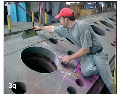
Bild 3: Arbeitsschritte beim Reparaturschweißen am Beispiel eines Schiffdiesel-Zylinderblockes bei der Firma Casper Hahn in Remscheid (Teilbilder 3a bis 3q, Seite 15 - 16)
