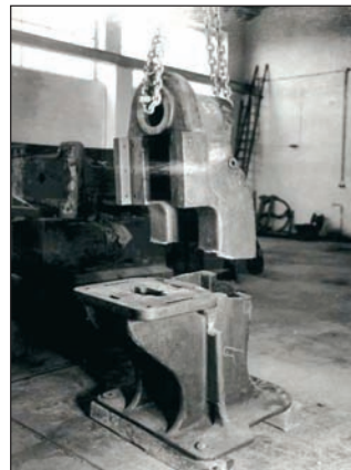
Bild 7: Durchbrochener Ständer einer Exzenterpresse aus EN-GJS-400-15, der artgleich wieder geschweißt wurde.
