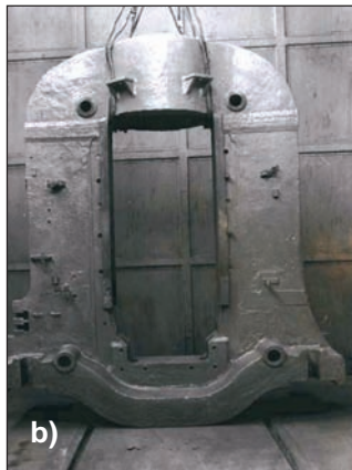
Bild 5: Zerbrochenes (a) und geschweißtes (b) Ständergussteil für eine Spindelpresse aus EN-GJL-250
