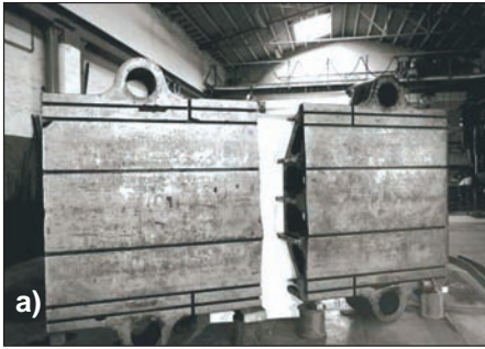
Bild 4: In zwei Teile zerbrochener Maschinentisch einer Viersäulenpresse aus EN-GJS-400-15 vor (a) und nach (b) dem Reparaturschweißen
