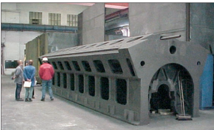
Bild 1: Der zu schweißende Schiffsdiesel-Motorblock aus EN-GJS-400-18, Gewicht etwa 120 t
