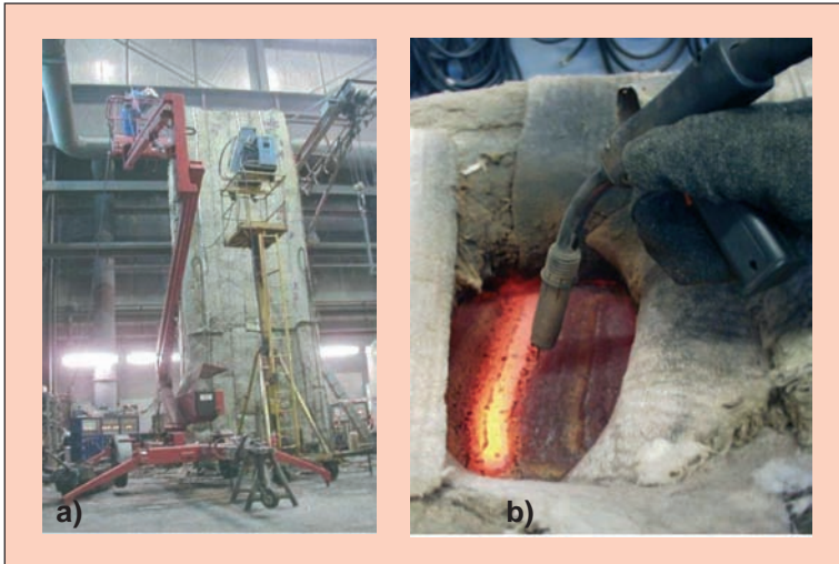
Bild 3: Gusseisenschweißung an einem 53-t-9-Zylinderkurbelgehäuse aus EN-GJS-450-10U in 10 m Höhe (a) mit artgleichem Schweißzusatz als MAG-Fülldrahtschweißung (b) (Bilder: Siempelkamp Gießerei, Krefeld) (oben)
